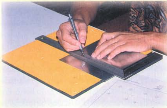
Figura 8.18. Midiendo la posición de las perforaciones. Esto facilita el uso del taladro
